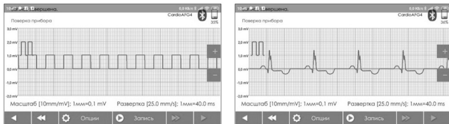
Рис.18-19. Форма калибровочного и испытательного сигналов прибора, отображенная в мобильном приложении
