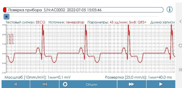
Рис. 14. Вид испытательного сигнала «0,75 Гц, 5,0 мВ, QRS+» при стандартной чувствительности экрана 10 мм/мВ (100 мкВ/мм)
