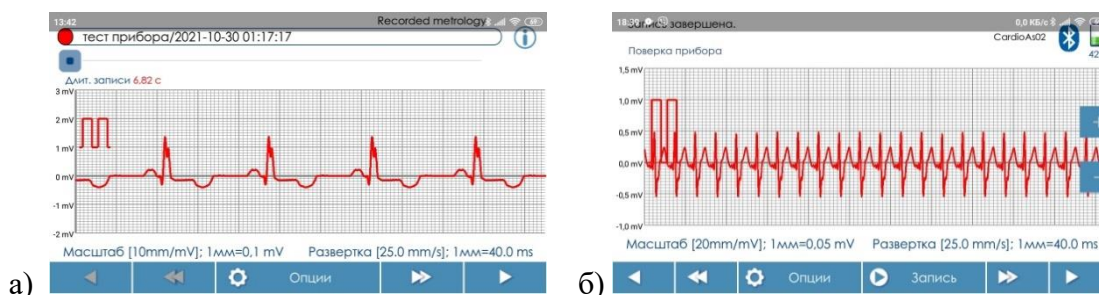
Рис.22 Примеры записи сигналов с частотой пульса 30 ударов/мин (а) и 240 ударов /мин (б) при развертке 25 мм/с
