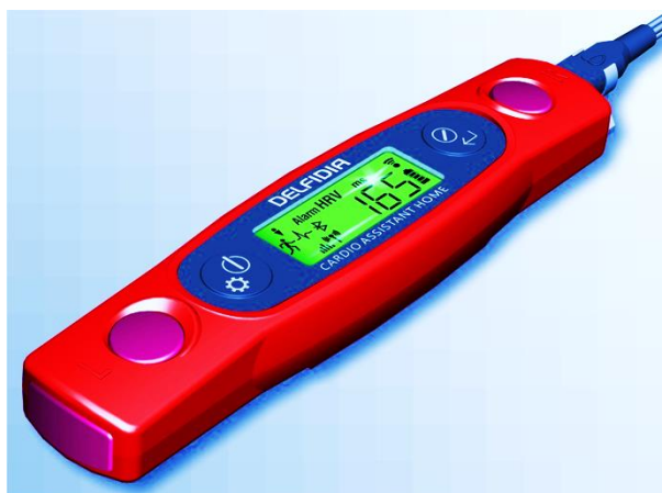
Рис. А-1 Модель Cardio Assistant HOME (АЕВМ 941311.003-00 LCD) - прибор с цифровым жидкокристаллическим дисплеем и модулем Bluetooth
