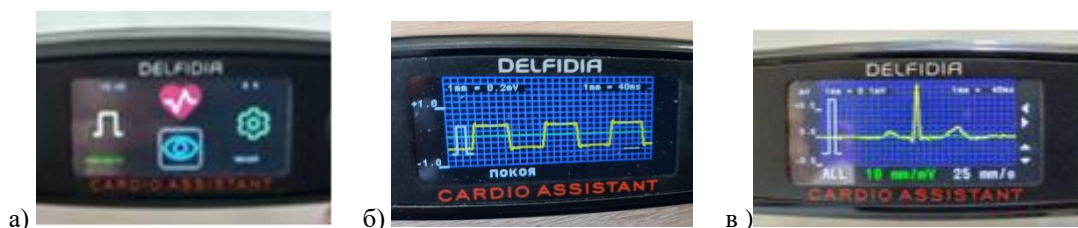
Рис. 28. Основные экранные формы дисплея модели PRO: а) главное меню; б) калибровочный сигнал 1,0 мВ; в) натурный сигнал ЭКГ
