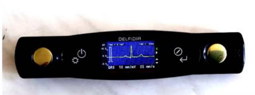
Рис. А-1 Модель Cardio Assistant HOME (АЕВМ 941311.003-00 LCD) - прибор с цифровым жидкокристаллическим дисплеем и модулем Bluetooth
