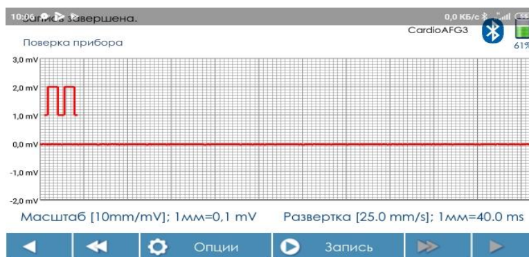
Рис. 9. Сигнал «Шум 0 мВ, 0 Гц» при чувствительности экрана 10 мм/мВ
