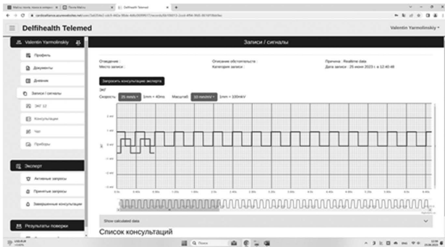
Рис.12 Калибровочный сигнал прибора, фиксируемый с помощью приложения в личном кабинете консультативного портала
